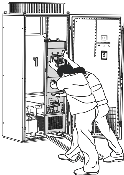
图 3-21 完成变频器进柜
