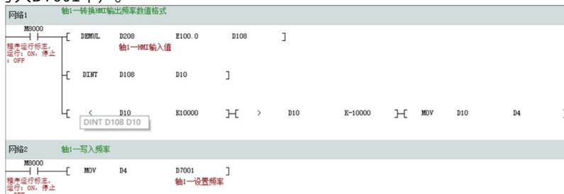
2. 对变频器进行启停控制，将所需站号的控制字所对应的D元件进行赋值，就能实现变频器的通信控制正转、反转、停机。控制字的定义如下：（0：自由停机；1：正转运行；2：反转运行；3：点动1；4：点动2；5：自由停机；6：按停机方式停机；7：故障复位；8：紧急停机）。控制字对应PLC的软元件地址是D7000，所以只需要给D7000值写为1，就可实现通信控制正转。同理，需要停机则需要设置D7000为5。
