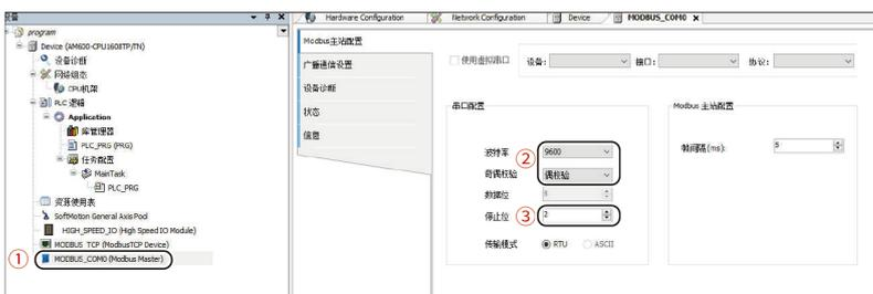
6. 双击左侧“Network Configuration”，双击右边串口中的COM端口中的ModBus选项，屏幕中央的ModBus总线上多了一个从站设备。若有多个从站，则多次点击ModBus即可生成多个从站设备。
