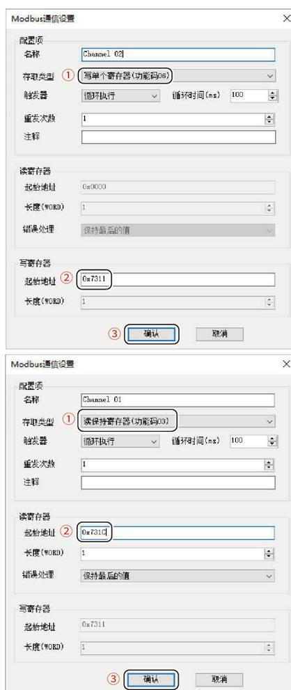
11. 在 Internal I/O映射中，将PLC中的变量映射到变频器的地址中。
