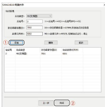
4. 写入操作：添加完成之后，选择PLC进行设置写入变频器的D元件的配置。
