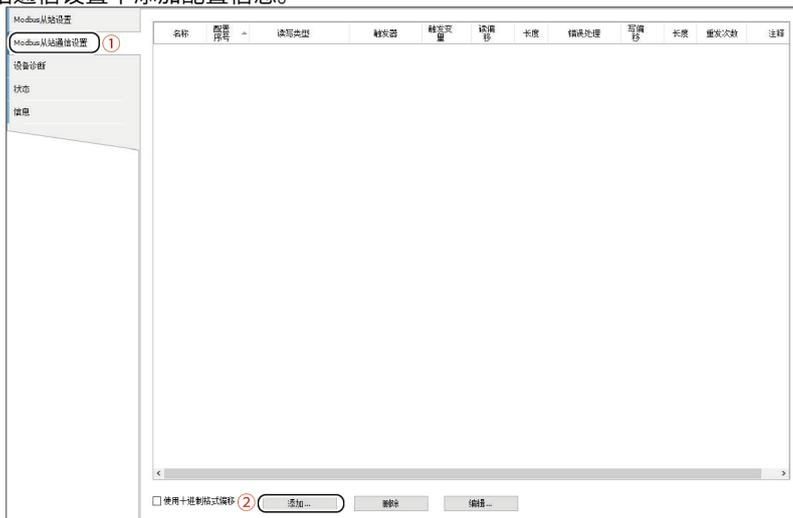
10. 在弹出的窗口中，配置寄存器信息。变频器的控制字读地址为731CH，写地址为7311H，频率地址为7310H。
