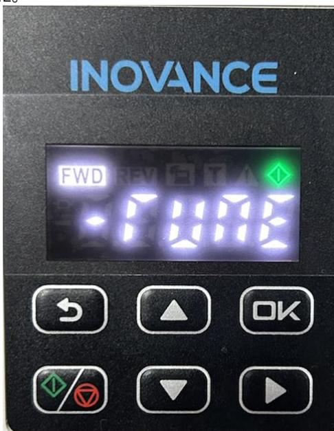
4. 按下确认开始键，电机调谐开始，当面板显示50.00，表示调谐完成。
