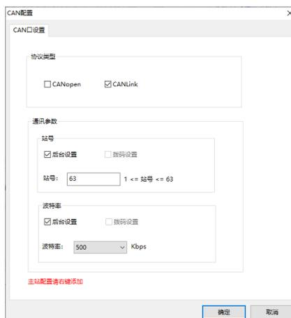
3. 点击 CAN(CANLink) 点击“添加CAN配置”，出现 CANlink配置 双击“CANlink配置”，在弹出的第一个界面点击“下一步”，然后在弹出的第二个界面按如下步骤设置。
