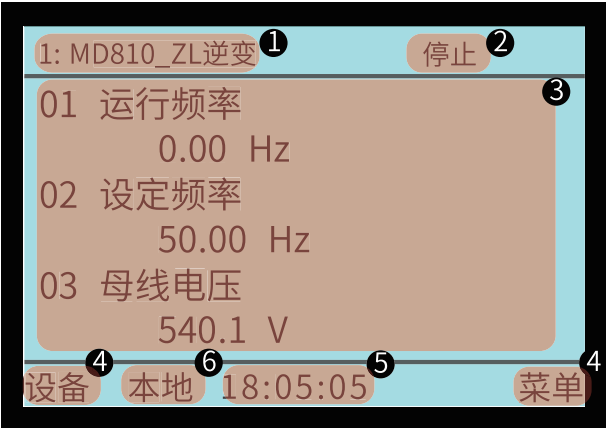
图5-2 外引LCD键盘主界面示意图
